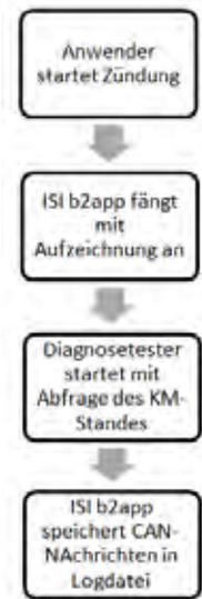
**Abbildung 8: Prozessablaufdiagramm zur Aufzeichnung der CAN-Nachrichten**
