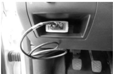
**Abbildung 11: Das umgelötete OBD-ISIb2air-Kabel**
