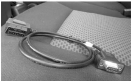
**Abbildung 10: OBD-Standard-Kabel DSUB-9**
