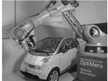
**Abbildung 3: Optischer Messroboter [3]**
